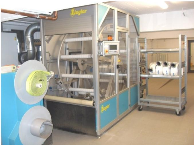
Die Druckprüfung der Schläuche wird von einer unterwiesenen Person durchgeführt. Hier muss auch besonders auf den Arbeitsschutz geachtet werden. Handschuhe und Kapselgehörschutz ist Pflicht.
