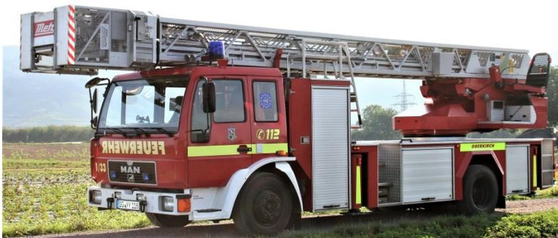
Die Drehleiter mit Korb (DLK 23/12) der Freiwilligen Feuerwehr Oberkirch hat bei einer Ausladung von 12 Metern eine Nennrettungshöhe von 23 Metern.
