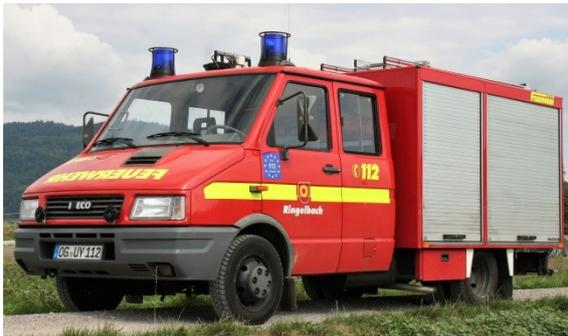
Der Einsatzabteilung Ringelbach steht ein Tragkraftspritzenfahrzeuge mit Wasser (TSF-W) zur Verfügung.
