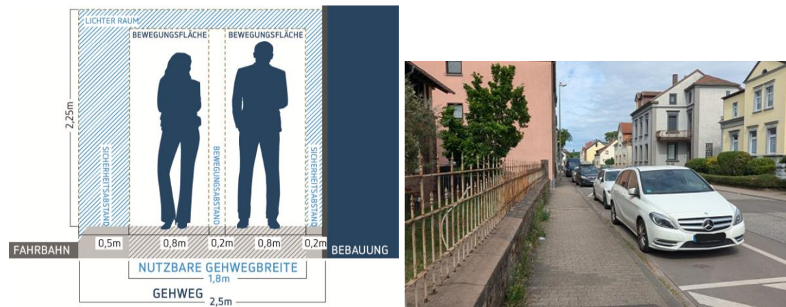
Abbildung 29: Platzbedarf auf Gehwegen und eingezeichnete Parkflächen auf der Fahrbahn
