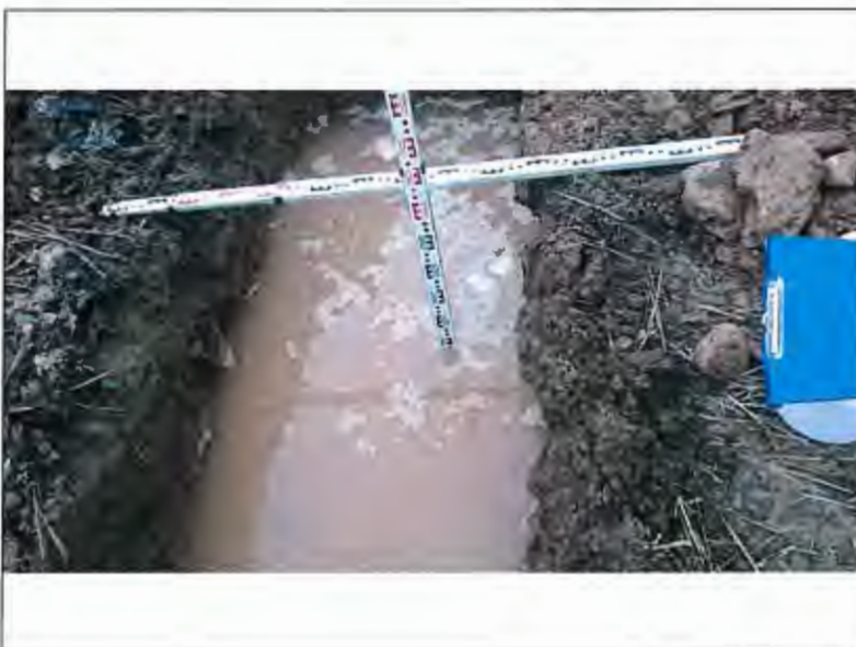
Abb. 21: VV 2 nach einer Wartezeit von ca. 30 min. Keinerlei Absenkung des Wasserspiegels zu beobachten
